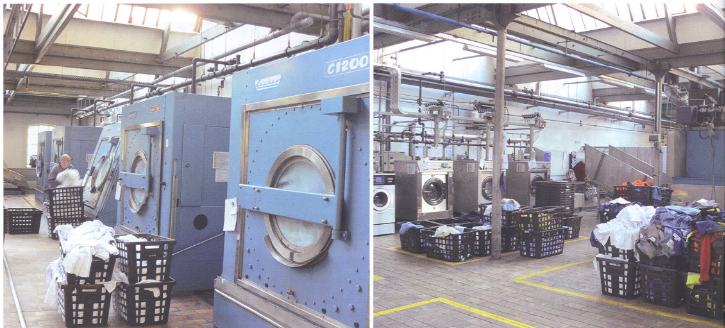
De g. à d. : tous les vêtements sont lavés en grosses laveuses essoreuses de plus de 100 kg. Les petites machines sont également indispensables pour traiter séparément les vêtements spéciaux ou les petites quantités.
