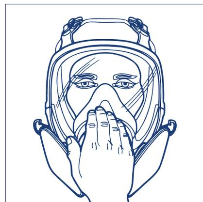
3. A chaque mise en place du masque complet, vérifier l'étanchéité par pression positive et/ou négative.
